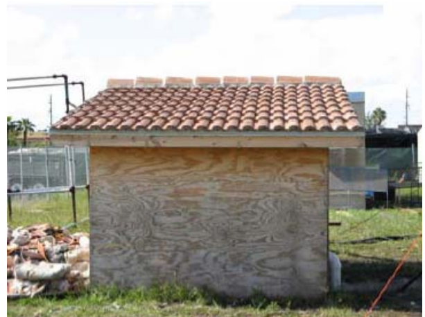
(d) Model 3: Concrete Roof Tiles with Foam
